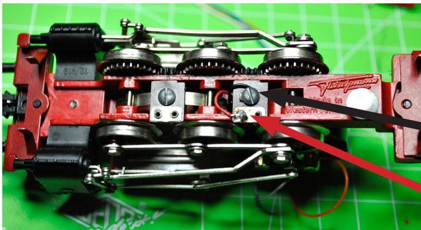
Die Kabel vom Radschleifer rechts (rot) und der Masseanschluss (schwarz) werden mit dem Decoder verbunden.
