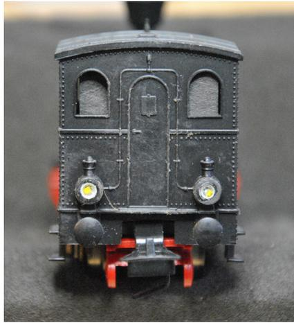
Die Scheinwerfergehäuse wurden mit NOCH Modellbauwasser aufgefüllt, so sind die LEDs gleichzeitig fixiert und das Licht wirkt gelblich.
