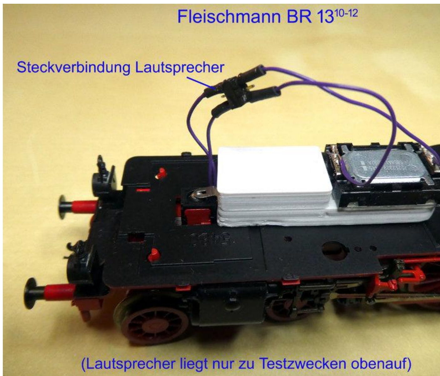
Steckverbindung Lautsprecher. Der LS liegt hier nur zu Testzwecken auf dem Umlauf.
