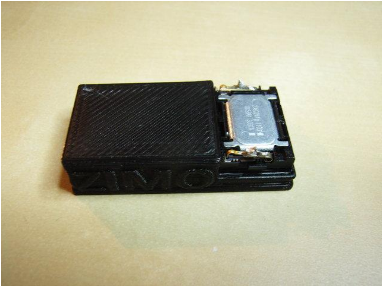
Dieser 8 \Omega /1 W Lautsprecher, ein Dumbo 13x18 mm mit großer Schallkapsel (40x20x9 mm) von Zimo...
