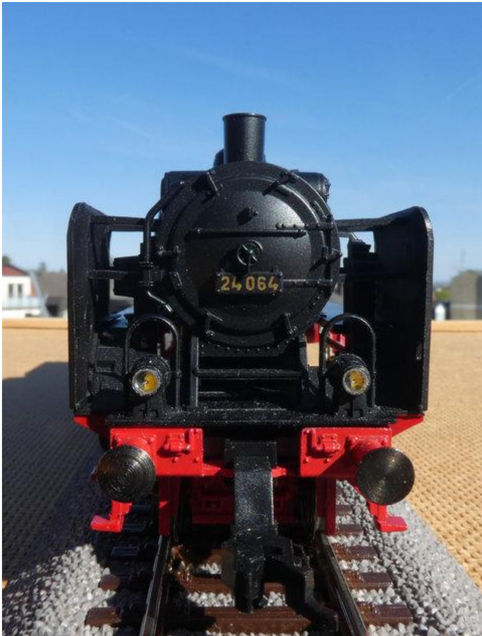
Lokbeleuchtung mit LEDs in den Laternen – wenn's fertig und alles wieder montiert ist.
